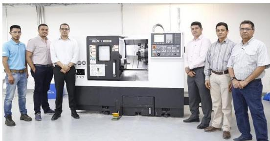
UTS adquiere moderno Torno CNC para laboratorio de Ingenierías. Se trata de un Torno de Control Numérico Computarizado (CNC) que se utiliza para la fabricación de piezas metalmecánicas mediante un software. El CNC funciona con datos alfanuméricos, siguiendo los ejes cartesianos X, Y, Z. En la industria es el encargado de producir piezas como ejes, tornillos, tuercas, arandelas, engranajes, pernos, entre otras, con alta precisión.
